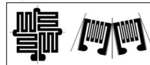
**Abb. 1:** Grundstruktur der generativ gefertigten DMS
