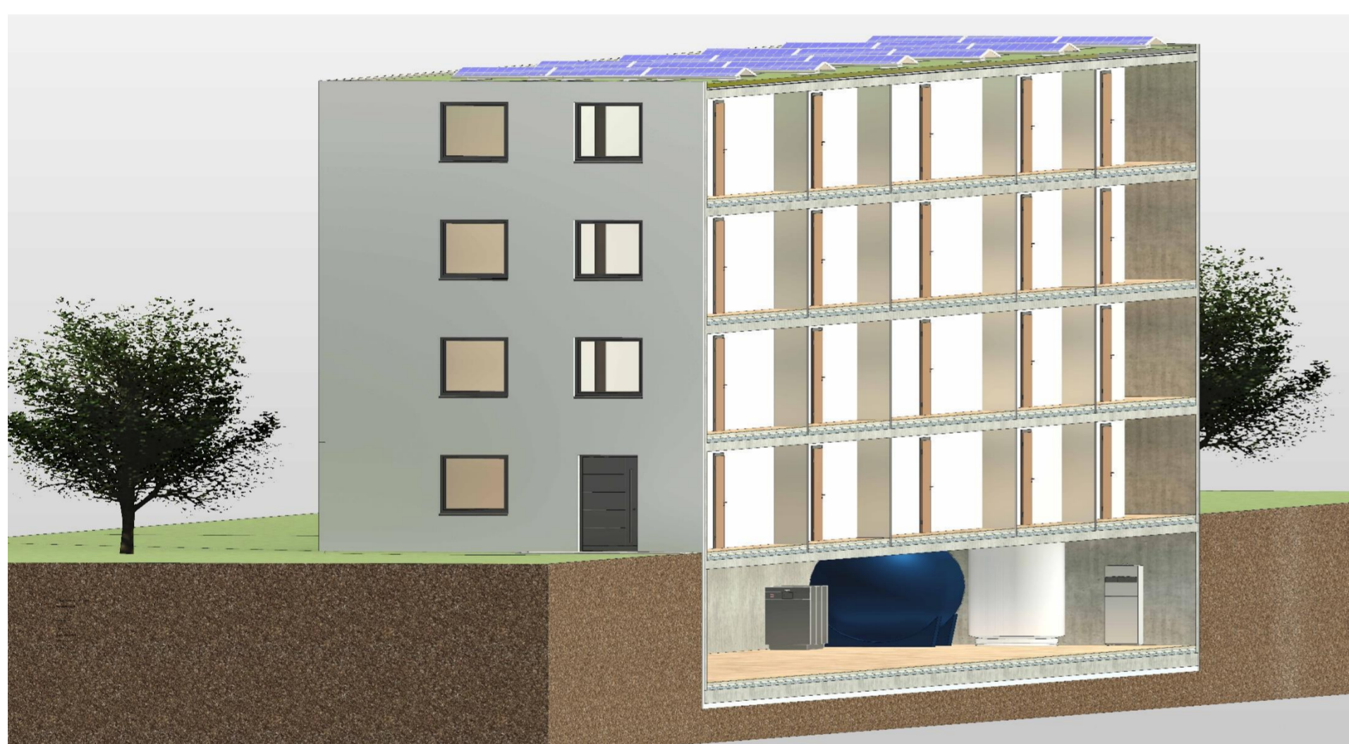
Abb. 1: Beispielhaftes Mehrparteienhaus mit Wärmepumpe, Photovoltaikanlage und Wassertanks 1
